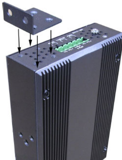
图 2.15： 安装金属支架套件
