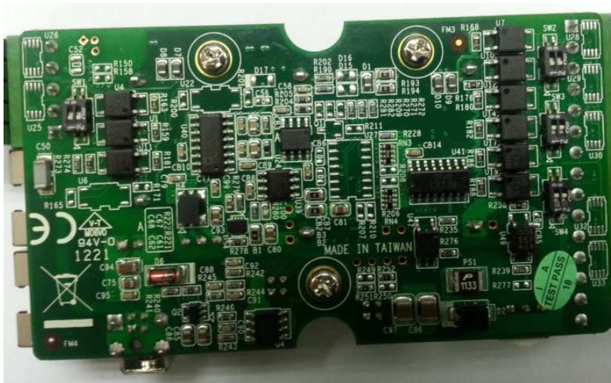
Adam-6217 电压/电流模式 SW1~SW4 拨码示意图
